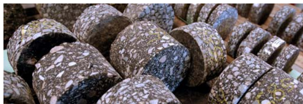
Asfaltprøverne hedder på fagsprog borekerner. Resultaterne af asfaltprøverne indgår i det videre arbejde med at dimensionere belægningen, så det sker optimalt i forhold til fx økonomi og miljø. (foto: Pelle P)
